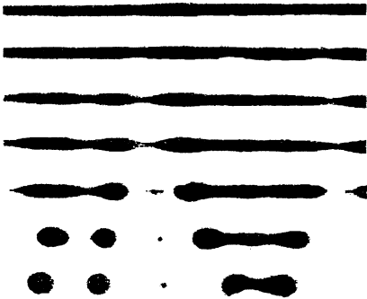
图 2 在 310℃ 时 PES 基体中 Vectra A900 纤维破裂过程的电镜照片 开始长度为 10.14m; 从上到下 t 为: 0, 15, 42, 53, 72, 101, 155(s) [16]
